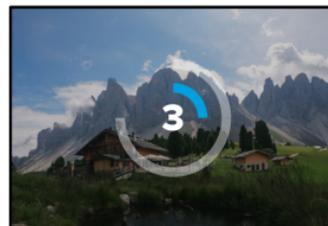
*Hinweis:* Um bei schlechten Lichtverhältnissen möglichst scharfe Aufnahmen zu erzielen, wird der Selbstausröser automatisch auf 3 Sekunden eingestellt, wenn du in den Nachtfotomodus wechselst.
