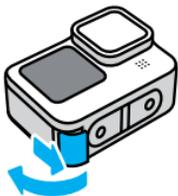
2. Schiebe die SD-Karte bei ausgeschalteter Kamera und entnommenem Akku in den Kartensteckplatz; das Etikett muss dabei zum Akkufach zeigen.
